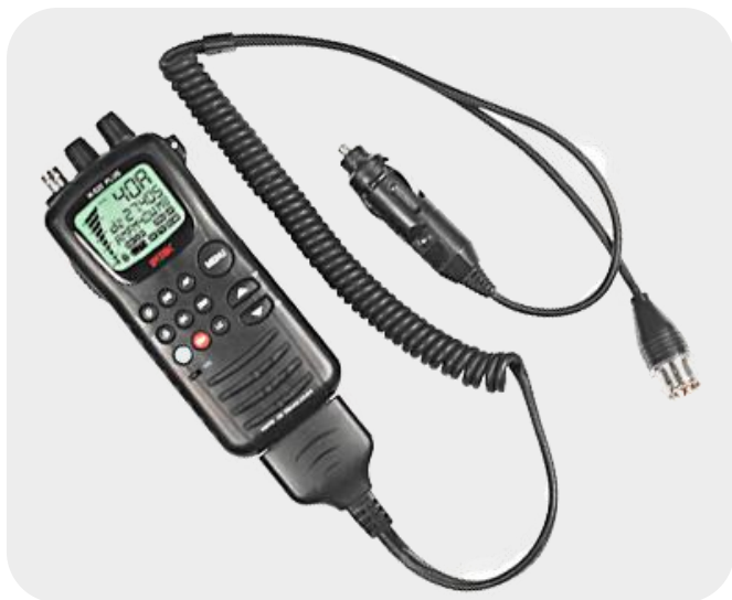
Maitinimo laidas "CAR-520" – papildomas maitinimas iš akumuliatoriaus + galima prijungti išorinę anteną
