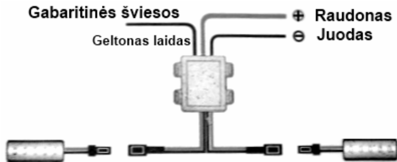
1 pav. Visų LED dienos šviesos žibintų pajungimas išskyrus LK bloko
